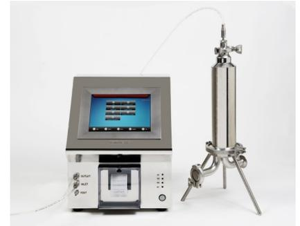
Nell'ambito delle produzioni farmaceutiche e del confezionamento asettico, i sistemi di filtrazione, per assicurare le corrette performance, devono essere sottoposti a controlli prima e dopo l'uso. Beamatic 3.0 è un innovativo strumento di misura progettato per verificare l'integrità dell'elemento filtrante all'interno delle aree protette ad atmosfera controllata o nei laboratori.
